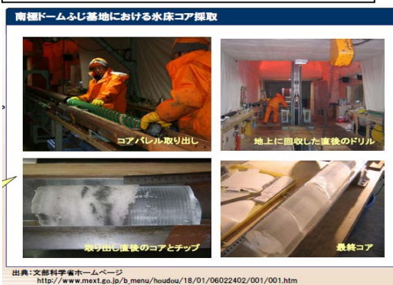
図12. 氷床コアの採取・分析状況
